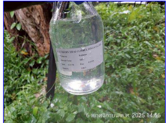
รูปที่ 3.2 แสดงการเก็บตัวอย่างน้ำผ่านการบำบัดน้ำเสียรวมของโครงการ (Effluent)
